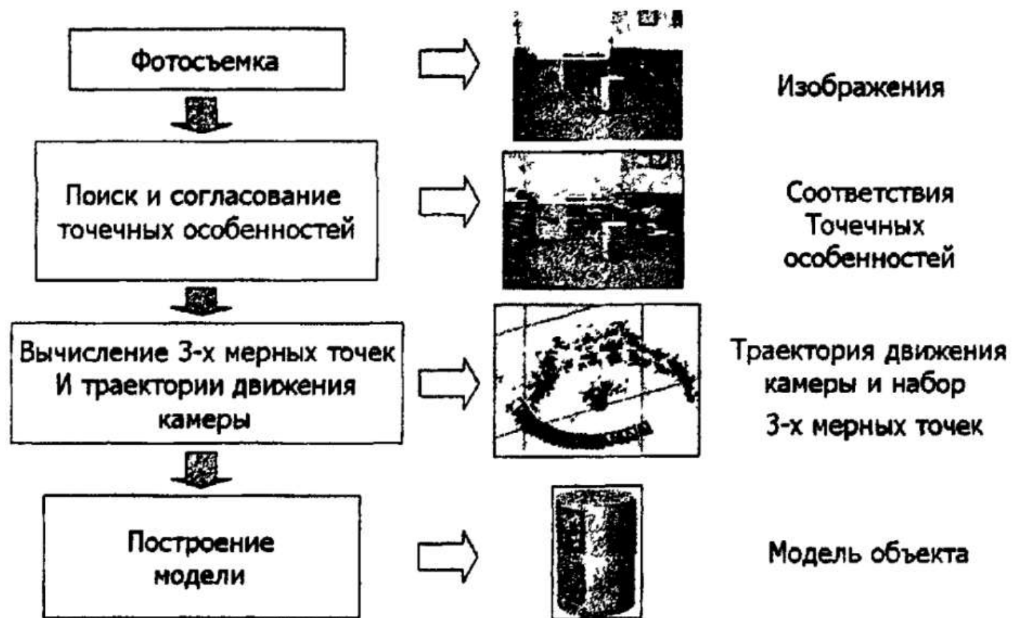
Рис. 2 Общая схема работы системы построения 3-х мерных моделей по набору изображений
